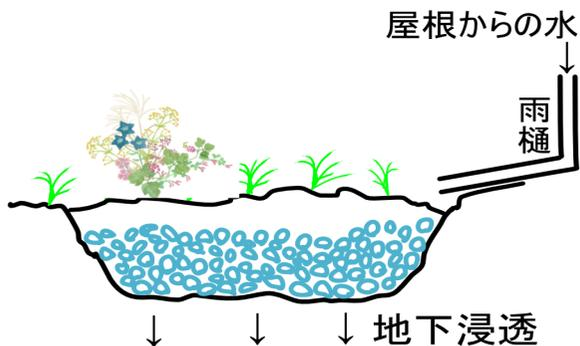
雨庭とは屋根などにふった雨を一時的にためてゆっくりと地下に浸透させる庭です。設置することにより河川に流れ出す水をかなり減少させることができます。山下宅に設置予定です。
